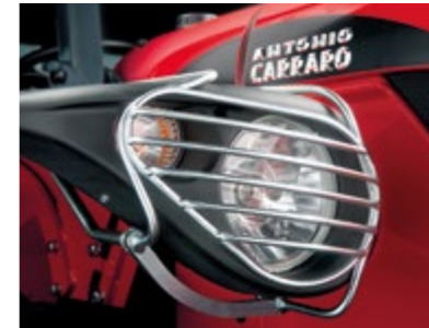
GRILLE DES PHARES Outre d'embellir la carrosserie, ces grilles ont une fonction de protection intégrale des phares.
