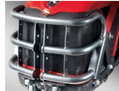
PARE-BUFFLE Élément en tube d'acier pour protéger la carrosserie ; il intègre l'attelage du troisième point avec la combinaison du relevage avant.
