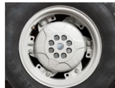
BRIDES ARRIÈRE EN FONTE Brides qui augmentent le poids arrière du tracteur.
