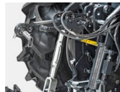
TIRANT VERTICAL ET TROISIÈME POINT HYDRAULIQUE Optimisation du positionnement et de l'inclinaison des équipements.
