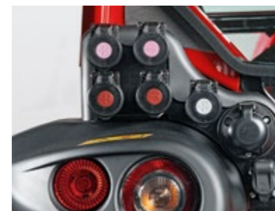
RACCORDS RAPIDES ARRIÈRE Système hydraulique électroproportionnel commandé par joystick « JPM » avec double système de sécurité de l'opérateur et unité de commande intégrée avec configuration et réglages personnalisables - 12 raccords rapides arrière.
