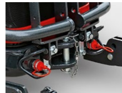
RACCORDS RAPIDES AVANT Relevage hydraulique avant équipé de l'attelage 3-points + 1 DE avant répliqué (2 raccords rapides AV).
