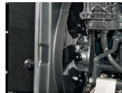
ACS (Air Clean System) Ventilateur moteur avec inversion du flux. Réduit la nécessité de nettoyer les grilles frontales et améliore le refroidissement du propulseur.
