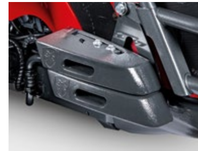
MASSES AVANT Les masses sont parfaitement intégrées à la carrosserie du tracteur sans altérer l'empattement ni l'encombrement de la machine.
