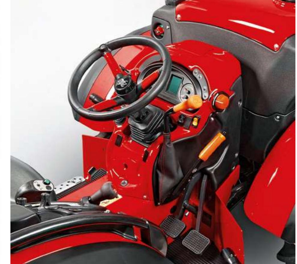
Pour l'inverseur, une recherche ergonomique sur le poste de conduite a démontré que son emplacement optimal se trouve à droite, à côté des commandes de relevage et des distributeurs. Ceci permet de les actionner tous de la main droite afin de garder fermement la main gauche sur le volant pour mieux contrôler le véhicule en cas de danger.
