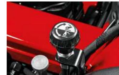
**COMMANDE DE RÉGLAGE DE LA HAUTEUR MAXIMALE DE RELEVAGE**
