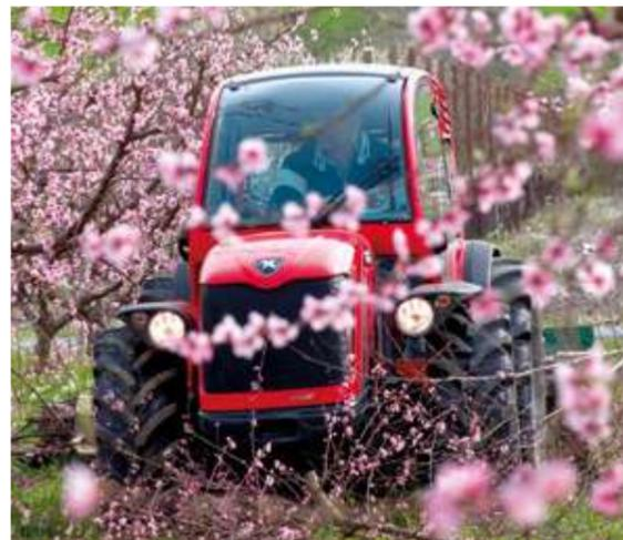
Un volant à hauteur et à inclinaison réglables, un siège avec ceintures à enrouleur (également sur la version pneumatique en option) et une large plateforme promettent un confort de type automobile qui allègera les longues journées de travail des opérateurs assis sur le TGF.
