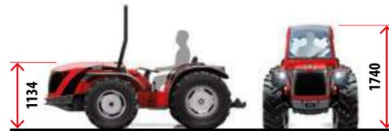
Sur un TGF, l'opérateur dispose du poste de conduite le plus bas de sa catégorie : il se trouve à 113,4 cm du sol dans la version avec arceau rabattable, et à 174 cm dans la version avec cabine.
