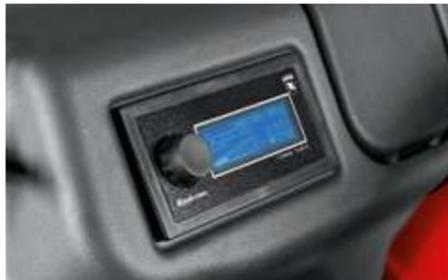
AirControl, un instrument numérique à cristaux liquides qui enregistre constamment les paramètres de la pressurisation à l'intérieur de la cabine en signalant les valeurs de la pression interne et les heures d'utilisation des filtres à charbons actifs **Cat. 4**.
