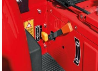
**SÉLECTEUR MÉCANIQUE** Sélecteur mécanique à 2 gammes (travail et déplacements).
