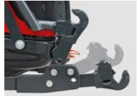
SOLLEVATORE ANTERIORE Il sollevatore anteriore permette le lavorazioni in combinata con le attrezzature posteriori.
