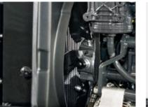
ACS (Air Clean System) Ventilateur moteur avec inversion du flux. Réduit la nécessité de nettoyer les grilles frontales et améliore le refroidissement du
