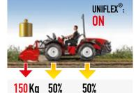
La suspension *UNIFLEX\** transfère une partie du poids de l'outil sur les roues.
