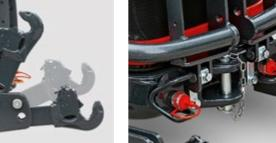
RACCORDS RAPIDES AVANT Relevage hydraulique avant équipé de l'attelage 3-points + 1 DE avant répliqué (2 raccords rapides AV).
