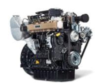
Les moteurs Stage 5 utilisés sont les meilleurs de la catégorie et ils assurent des performances de couple et puissance optimales tout en réduisant la consommation, le niveau de bruit et les émissions de carbone. Il s'agit d'un moteur Kohler 4 cylindres (2482 cm3), à aspiration turbo et injection Common Rail pour une puissance de 75 ch à 2300 tr/min avec couple maximum de 310 Nm à 1500 tr/min.
